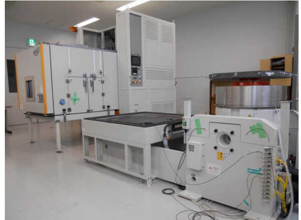
(奥：恒温恒湿部、手前：振動試験部)
